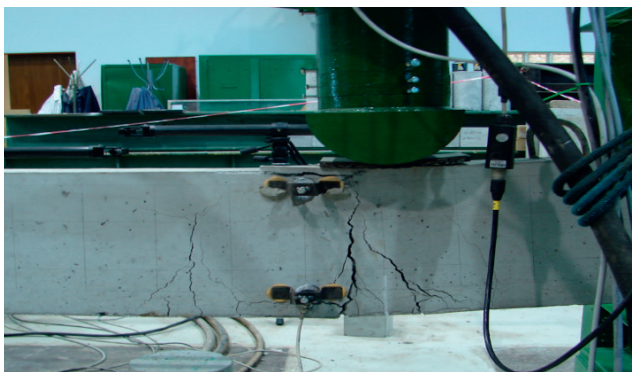
Fot. 3. Obraz zarysowania belki po zniszczeniu
