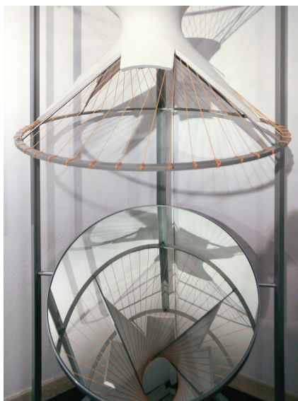
Model formotwórczy – hiperboloida paraboliczna oraz odwrócony model optymalizacyjny krzywych łańcuchowych sklepień
